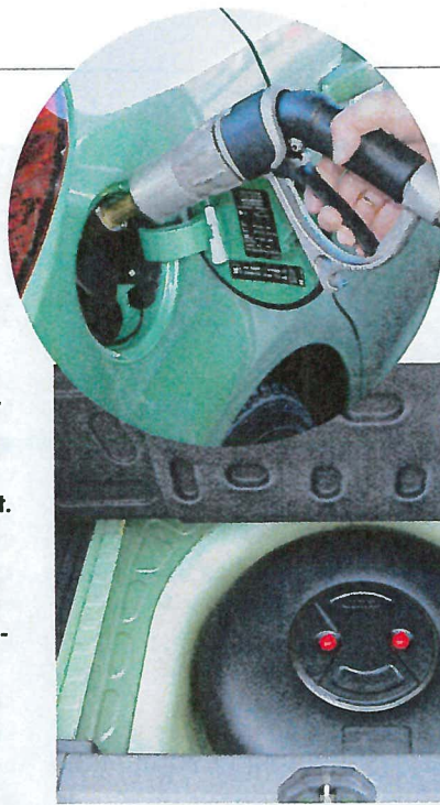
Lpg-tank en motor in nieuwe Opel. Tank zit op plek van reserveband
